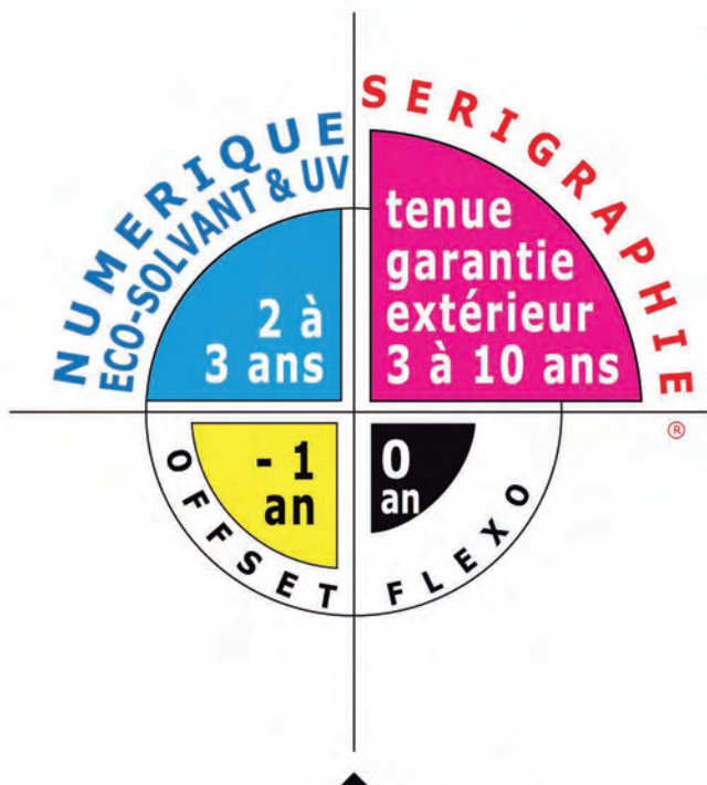
Diagramme de résistance en extérieur à la lumière UV des différents procédés d'impression les plus utilisés : Flexo, Offset, encres Eco-Solvant et encres UV Numérique grand format et Sérigraphie traditionnelle couleurs Pantone en tons directs.
