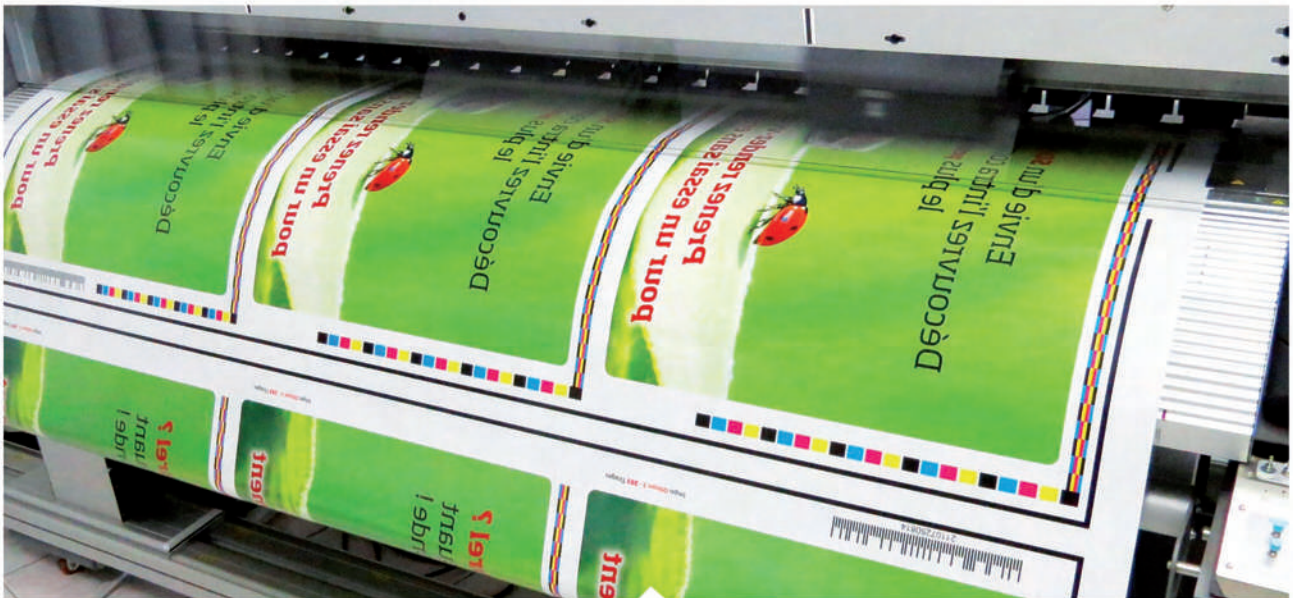
Imprimante numérique grand format en continu laize 160 cm, impression Haute-Définition 1400DPI Quadrichromie + Blanc de soutien partiel ou total.
