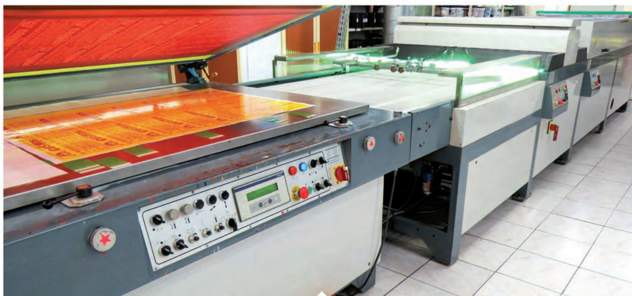
Ligne de sérigraphie 3/4 automatique format 80 x 120 cm avec deux systèmes de séchage des encres en tons Pantone directs à solvant ou UV.
